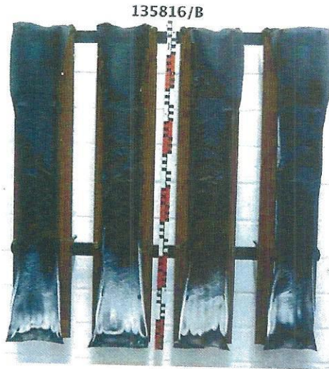
Bild 7: Aussehen des Probekörpers B nach 10-minütiger Beflammung
