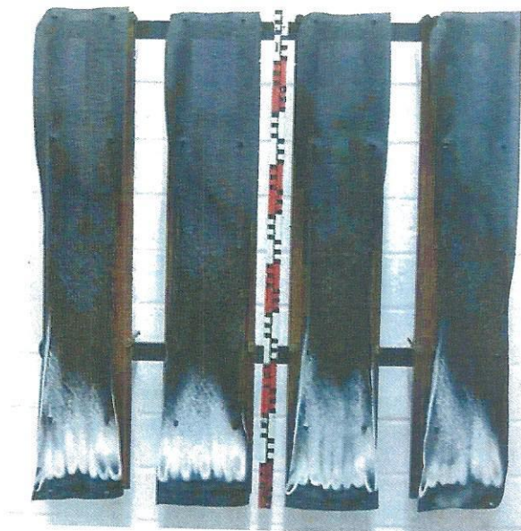
Bild 3: Aussehen des Probekörpers A nach 10-minütiger Beflammung
