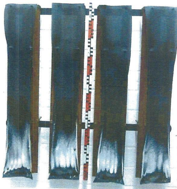
Bild 4: Aussehen des Probekörpers C nach 10-minütiger Beflammung
