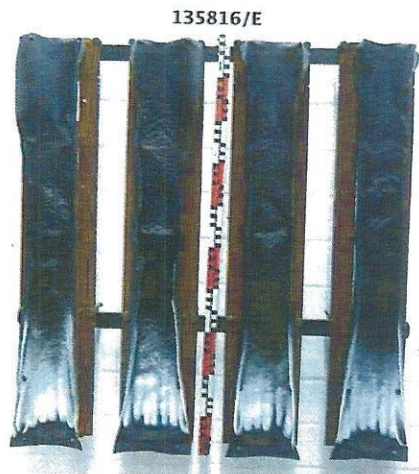
Bild 9: Aussehen des Probekörpers E nach 10-minütiger Beflammung
